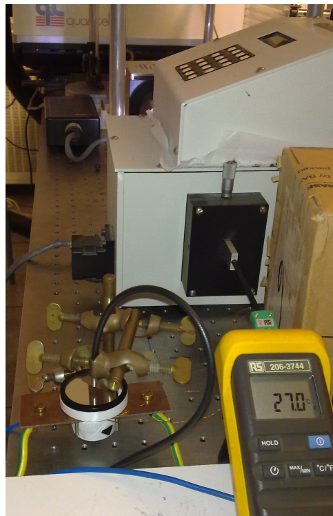
Fig.4.2 – Sistema di misura realizzato per rilevare variazioni nella trasmittanza del campione.
