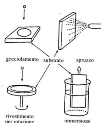
Fig.3.4 – Sono riportate alcune delle tecniche utilizzate nel metodo sol-gel.
